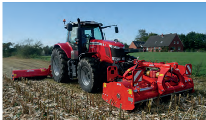
Uni-Mäher UMG 2800 in Kombination mit Uni-Seitenmäher USM
